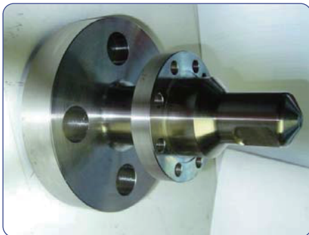
超高压阀体结构
