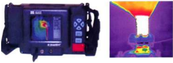
图5、红外成像仪及拍摄的温度分布图
