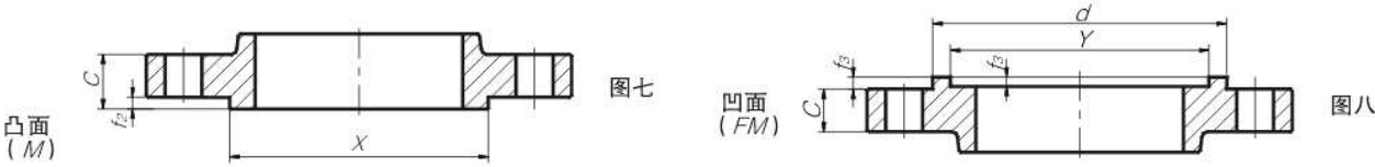
HG/T20615-2009 , 带颈平焊管法兰 凹凸面密封面尺寸 表7
